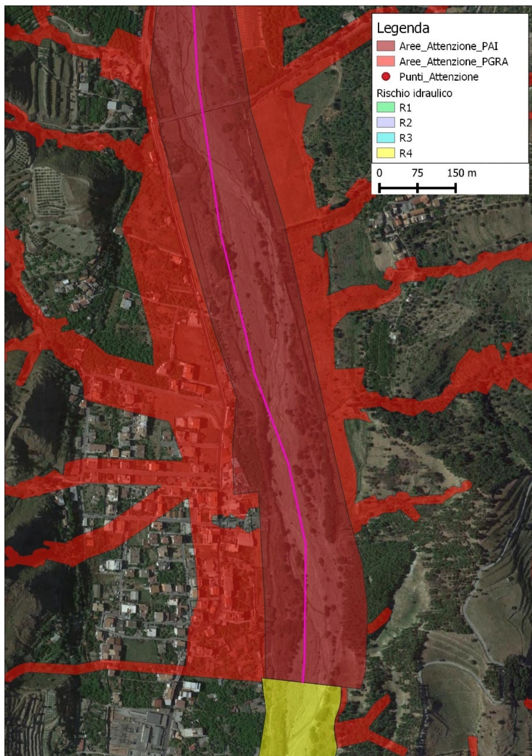
Piano Stralcio di Assetto idrogeologico dell'ex ABR Calabria - comune di Melito di Porto Salvo (RC) – Fiumara di Melito - Stralcio della mappa del rischio vigente
